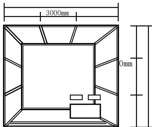
● 标准展位为 3m\*3m 展位, 高度 2.5 米, 材料为铝质型材和防火 PVC 板墙构成, 由展馆工程部搭建。
